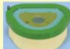
Das Modell kann durch Einblasen von Pressluft angehoben und entformt werden.
